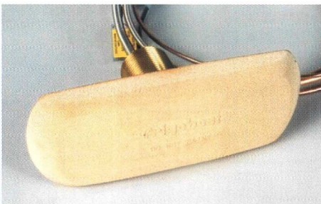
L'ÉCHANGEUR HORS COQUE EST FABRIQUE EN BRONZE MARIN ET TUBE CUPRO-NICKEL.
